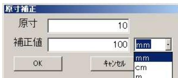
ここで測定した線分の長さを補正值に入力し、単位を選択してOKを押すと、縮尺が計算されます。
