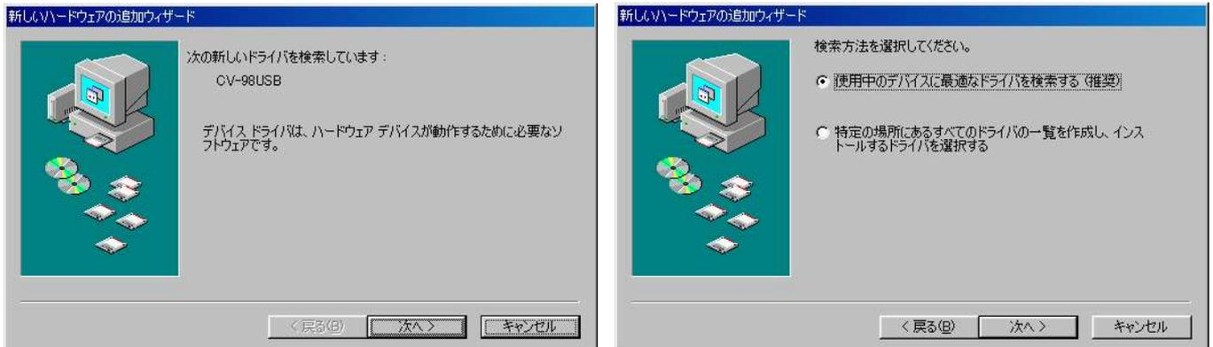
ドライバの場所を指定します。フロッピーディスクで入手した場合は「フロッピーディスクドライブ」をチェックします。弊社ホームページよりダウンロードした場合は「検索場所の指定 (L)」にチェックを入れドライバーダウンロードしたフォルダを指定します。
